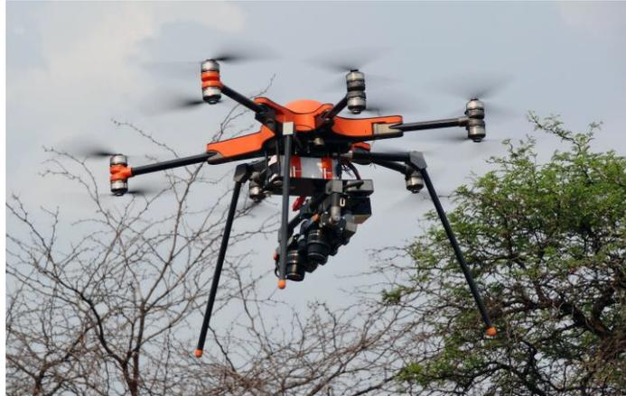
**Abbildung 3.3:** SoLeon-Multikopter coanda x12 während der Feldaufnahmen in Namibia. Am Gimbal sind drei Kameras montiert: Die zwei Nikon 1 V3 und eine zusätzliche Wärmebildkamera, wobei die Daten der Letzteren in dieser Arbeit nicht verwendet wurden (Foto: Cyrus Samimi).
