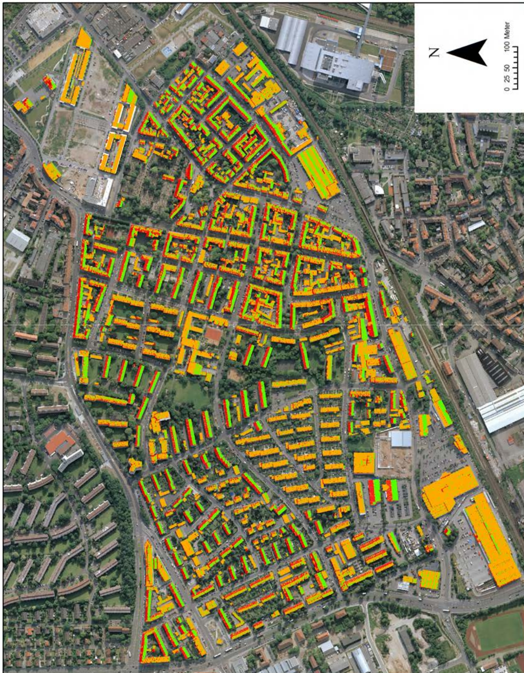
Abbildung 5.6: Errechnete gebäudebedingte Verschattung der Dachflächen
