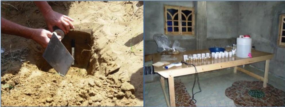
**Abbildung 15: Geländearbeit.** Links: Probenahme mittels Stechzylinder, Rechts: Analysenvorbereitung im provisorischen Labor. Fotos: Hudribusch (2010)
