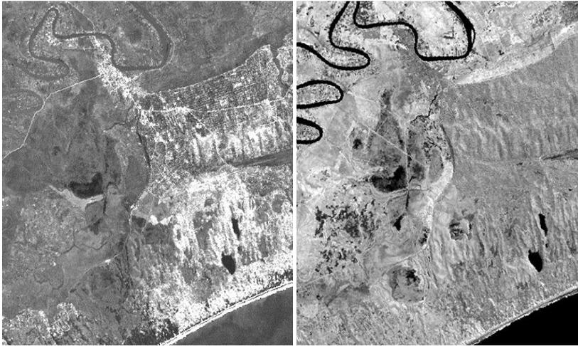
Abb. 29: Links: ETM+ Kanal 3 (0,6-0,7  $\mu\text{m}$ ), Rechts: ETM+ Kanal 4 (0,78-0,9  $\mu\text{m}$ ). Deutlich zu erkennen ist die stärkere Reflexion der unbewachsenen Dünen in Kanal 3. In Kanal 4 strahlen die Dünen deutlich weniger stark, Wasser überhaupt nicht, aber das bewachsene Talgebiet umso stärker
